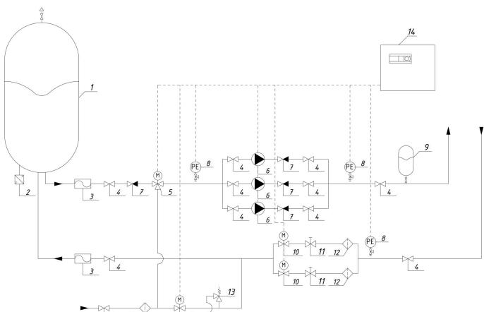
Установки состоят из компонентов Ридан: насосы, запорная арматура, контрольно-измерительные приборы и шкаф автоматизации.
